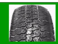
Le sous gonflage a provoqué, sur ce pneu, une usure sur les bords extérieurs de la bande de roulement, laissant la partie centrale de la bande moins endommagée.
