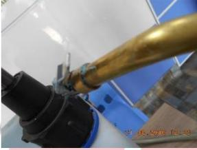
في بعض الاحيان يتم جفاف قليل من مادة SEAL على فتحة نهاية الانبوب المعدني بعد تكرار الحقن ، فيجب ازالة المادة المتيبسة بواسطة القشط و ليس الغسل بالماء لتجنب دخول الماء الى الاطار عند الحقن لاحقاً .
